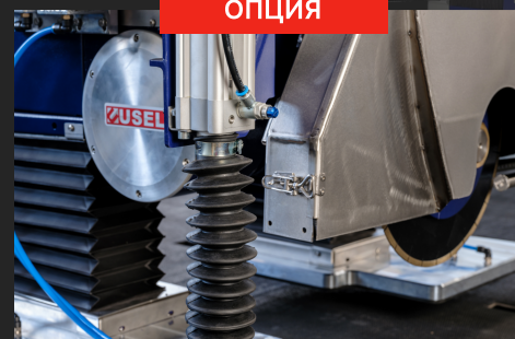
Система измерения толщины камня
