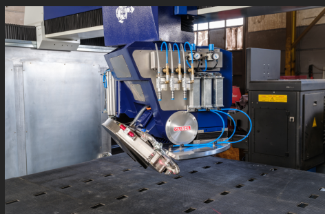
Наклон головки 0-90° (ось A)
