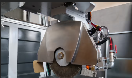
Автоматическое вращение головки 0 \div 90^\circ (ось С)
