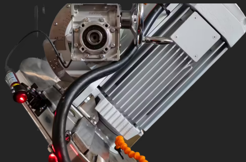
Двигатель мотора пилы 20 л.с. 3000 об/м
