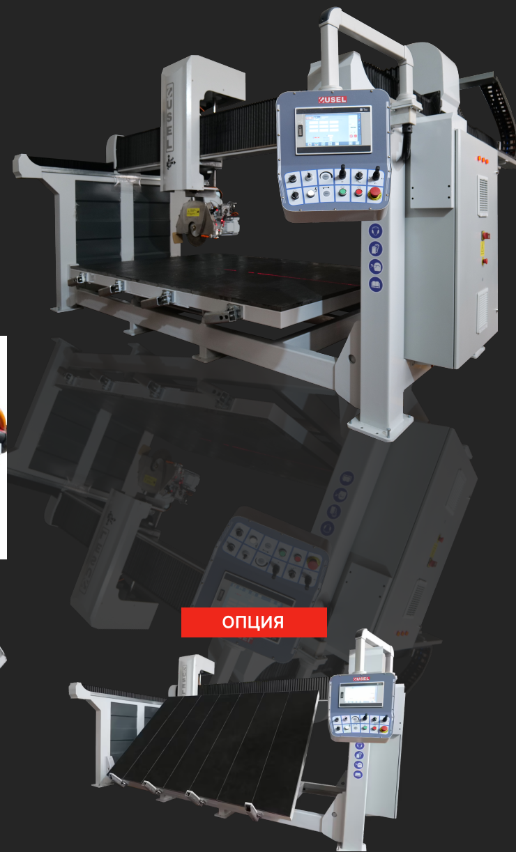
Гидравлический подъемный стол (горячее цинкование)
